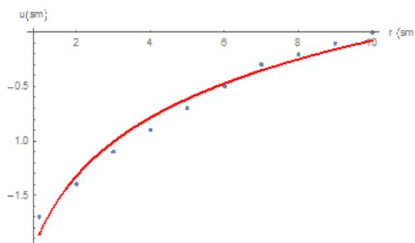
Рис. 1. Реальная зависимость прогиба от радиуса и график аналитического решения
