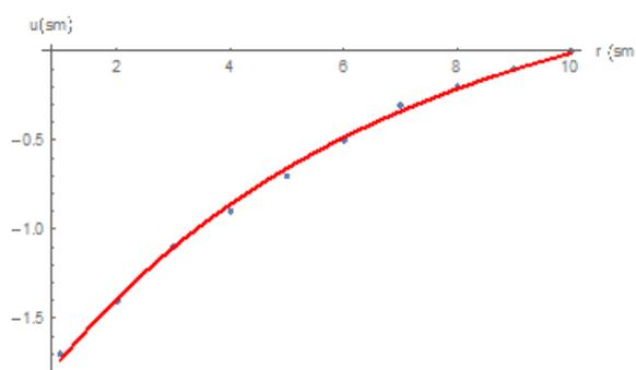
Рис. 2. Реальная зависимость прогиба от радиуса и график приближённого решения
