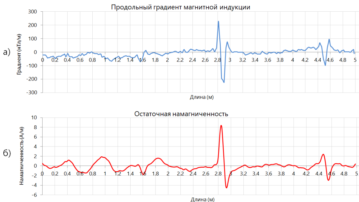
Рис. 1. Магнитный профиль бурильной трубы
