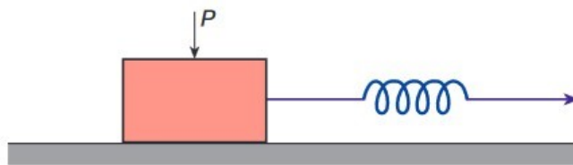
Рис. 1. Пример колебаний из-за сил трения.
