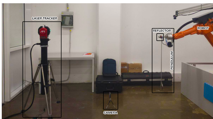
Рис. 1. Экспериментальная установка для измерения положения точки подвеса маятника с помощью лазерного трекера
