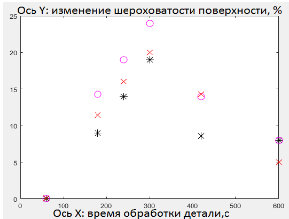
Рис. 1. Экспериментальные результаты обработки металлических поверхностей (электролит - водный раствор CaCl 2 с добавлением муравьиной кислоты)
