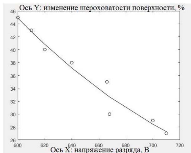
Рис. 3. Зависимость шероховатости поверхности от напряжения разряда (электролит - водный раствор салициловой кислоты)
