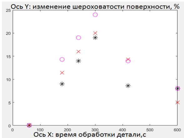
Рис. 1. Экспериментальные результаты обработки металлических поверхностей (электролит - водный раствор  $\text{CaCl}_2$  с добавлением муравьиной кислоты)
